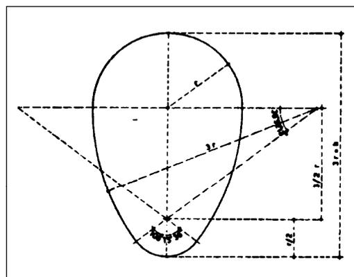
FIG. 22 - Condotti semiovoidali e ovoidali prefabbricati. Dimensioni indicative
