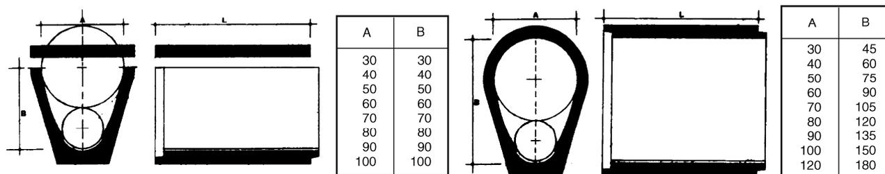
Qualora il rivestimento con fondi e piastrelle di grès dovesse riguardare tubi o fognoli ovoidali di cemento prefabbricati, il rivestimento potrà essere eseguito anche in fabbrica, curando comunque che all'atto del collocamento in opera la sigillatura tra i pezzi venga effettuata con leganti antiacidi.
