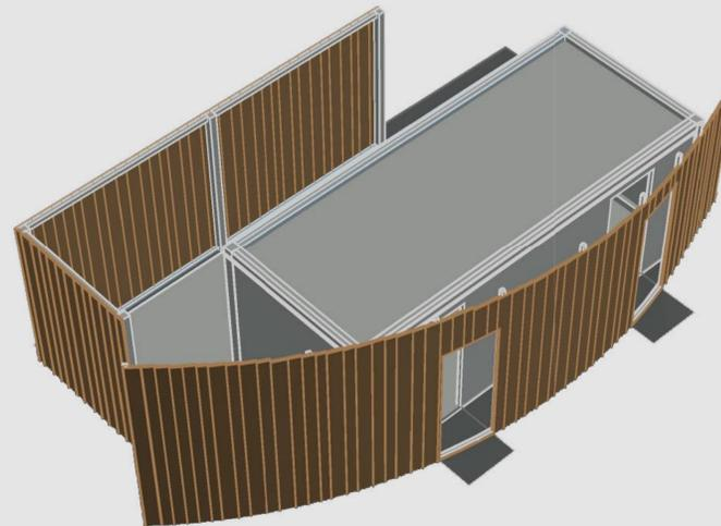
*Rivestimento frontale curvato sostenuto da una struttura metallica auto-portante*
